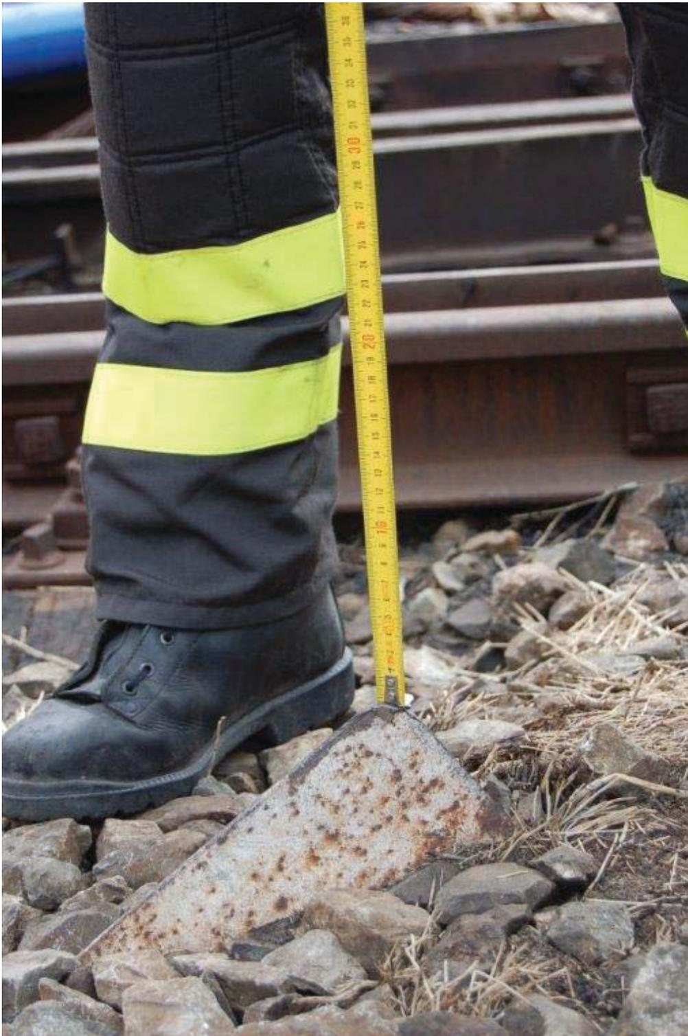
FOTO 40 - RILEVAMENTO DELL' ALTEZZA DEL PICCHETTO N 24 NELLA POSIZIONE STATICA FINALE
