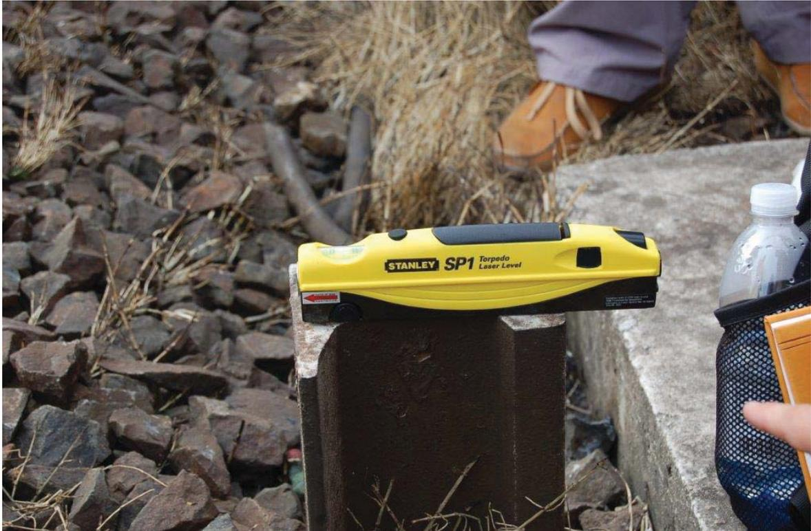
FOTO 37 - POSIZIONE DEL LASER PER IL RILEVAMENTO DELLE ALTEZZE DEL BINARIO E DEL PICCHETTO N 24
